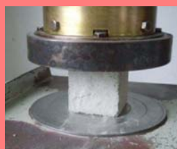
③ 加熱後の供試体 (促進養生供試体) の圧縮強度 (促進強度) を測定
