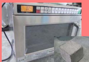
② 型枠に詰め込み 電子レンジで加熱 (促進養生)
