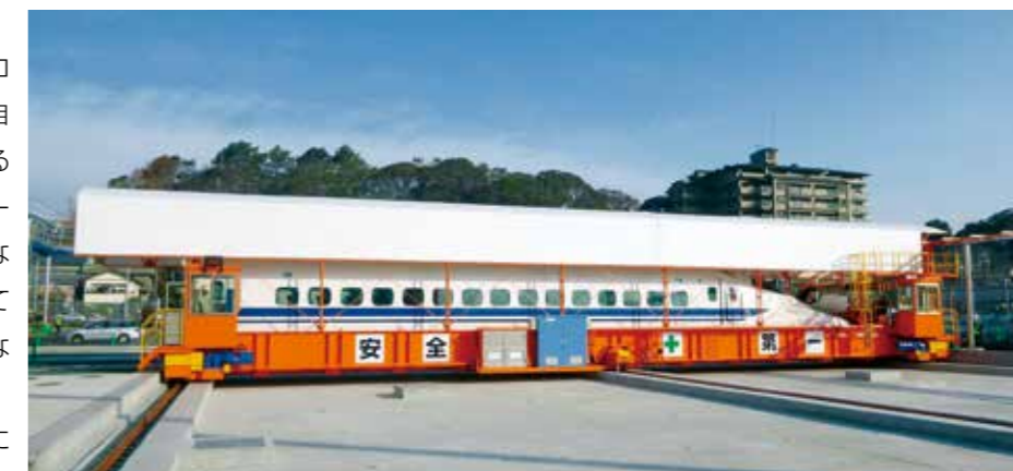
JR東海殿浜松工場向け車体搬送トラバーサー
