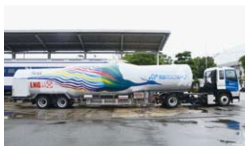
LNG Tank Trailers
