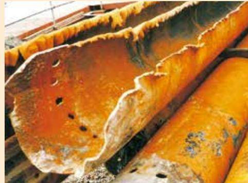
都市の再開発プロジェクト、橋梁・鉄塔などの建替工事など、近年、鉄筋コンクリート基礎・PCパイプ・H鋼杭・鋼管杭などの障害物が取り残されたままの地盤をケーシングにより掘削することが頻繁に行われています。ケーシングのカッタビットは鉄筋やH鋼などが切削できませんが、重要なことはこれらの障害物を確実に切削しながらケーシングを押し込むことです。過大な押込力によりカッタビットが障害物に食い込み、その回転反力によりカッタビットが障害物に食い込み、その回転反力で本体が振り回されると、杭芯がずれることがあります。B-CON機構により回転トルクを制御することで、その危険性は少なくなります。
