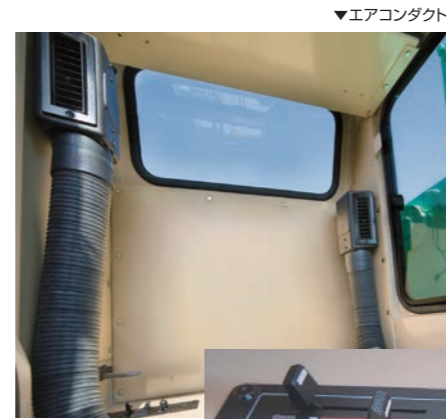
▼エアコンダクト
