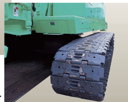
クローラ拡張作業中▶
