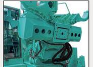
チェーンドライブの能力アップにより、オーガ押込/引抜き力が30%向上しました。地盤改良、先行掘削における引抜き作業に役立ちます。
