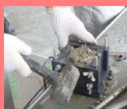
①出荷コンクリートを採取 (スランプ、空気量、温度も確認)
