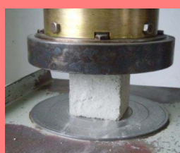
③加熱後の供試体 (促進養生供試体) の圧縮強度 (促進強度) を測定
