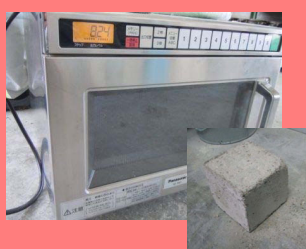
②型枠に詰め込み 電子レンジで加熱 (促進養生)
