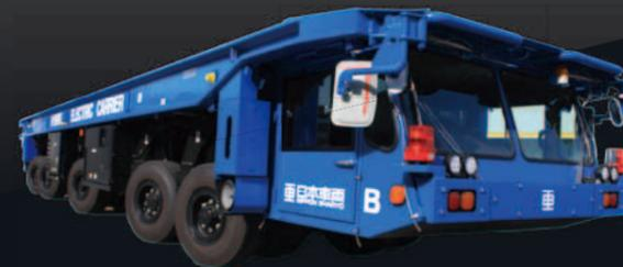
走行と操舵を電動化し、極めて高いエネルギー効率を実現する新世代電動式キャリア「NeGEM」。電動化することで、油圧機器や高圧の油圧配管、ホースを削減し、油漏れなどのリスクを大幅に軽減。
