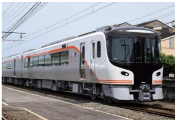
従来の気動車タイプと比較すると、省エネルギー一面では**燃料消費量を35%向上**、環境面では**CO<sub>2</sub>排出量を約30%削減**、**NOx排出量を約40%削減**したHC85系の量産車を、東海旅客鉄道株式会社殿向けに出荷を開始しました。
