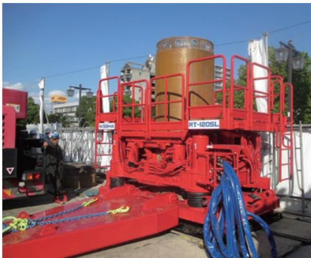
「全回転チュービング装置」は、場所打ち杭工法用の基礎工事機械の一つで、**施工中における騒音・振動などの環境負荷が少なく**、尚且つ掘削時に泥水を使用しないため、発生土の処理も容易に行える特徴があります。
