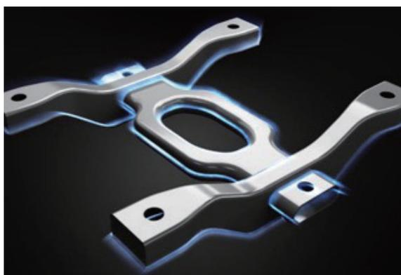
次世代プラットフォーム“N-QUALIS”シリーズの台車である「N S 台車」は、一体成型プレス鋼板の採用により、従来比で**重要溶接線長を約60%削減**しました。これにより、溶接作業に必要なエネルギーや材料を低減するとともに、定期検査時における探傷作業時間の大幅な短縮が可能です。
