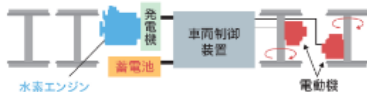
【水素動力ハイブリッドシステム(水素エンジン)】
