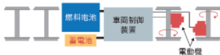
【水素動力ハイブリッドシステム(水素エンジン)】
