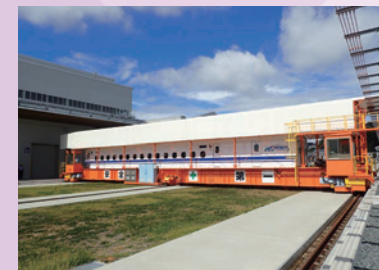
検修設備、車体トラバーサ
