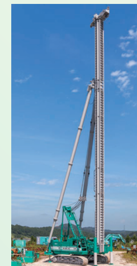
三点式大型杭打機
